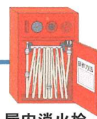
屋内消火栓設備
