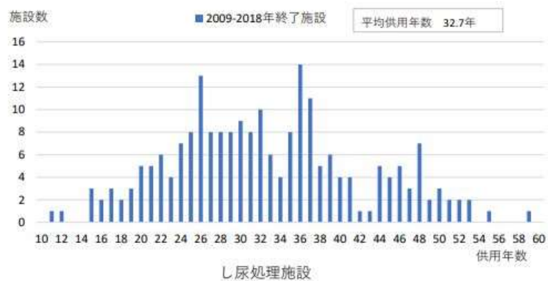
図3-11-2 し尿処理施設の稼働終了時の供用年数
